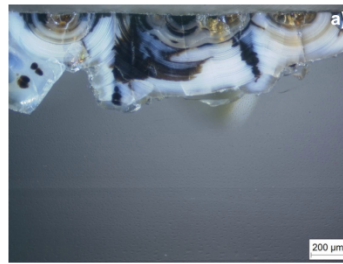
Photo 2 : Section d'un verre de vitrail atteint du phénomène de brunissement. En gris, le verre sain, en blanc le verre altéré (gel) et en brun les phases riches en Mn (PLOG).
