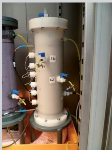
Mesures de la résistivité complexe en colonne sur un sable contaminé par du toluène pendant une biodegradation stimulée © BRGM - Cécile Noël
