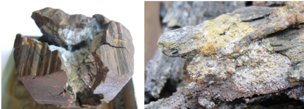
Figure 1 : exemples de spécimens pyriteux endommagés par des efflorescences de sulfates de fer. Vue de gauche : pyrite provenant des collections minéralogiques ; vue de droite : bois lignitisé fossile provenant de la Plaine Chevrrière (Paléocène, Oise)
