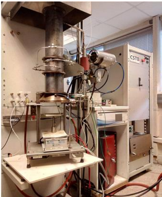
Banc d'essais feu cône calorimètre raccordé à un FTIR et à un ELPI (Electrical Low Pressure Impactor) pour les mesures de gaz de décomposition et d'aérosol du matériau étudié soumis à diverses agressions thermiques.
