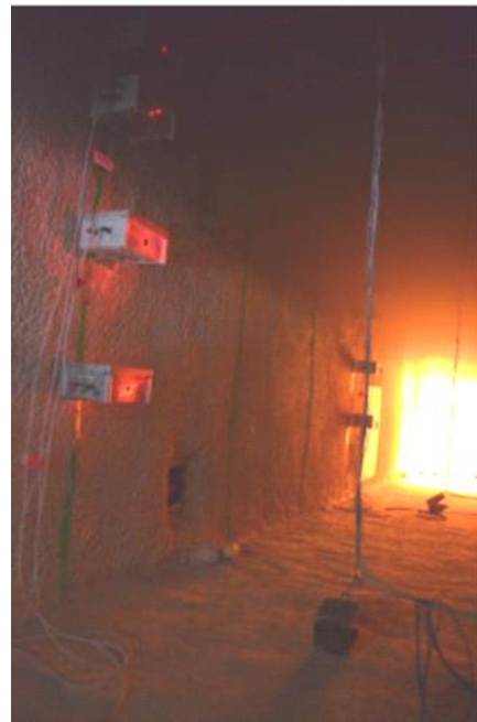
Essais feu échelle 1:1 dans une pièce couloir permettant de soumettre des œuvres sacrificielles à différents scénarios de feu réel.
